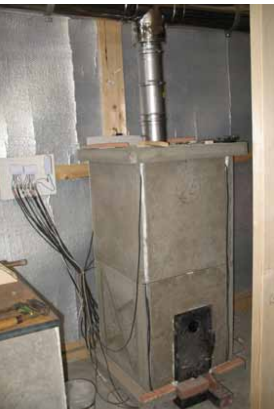
Proefopstelling Fin-oven. Deze uitvoering van onze kampioen milieuvriendelijke houtkachel kan desgewenst ook elektrisch worden verwarmd!
