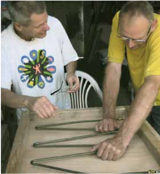
Matthieu en Dirk plaatsen het eerste thermo-elektrische profelement in de gietmal van een kachelwand.
