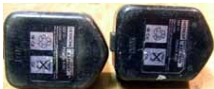
Twee gelijke accu's, waarvan de linker te heet geworden is; zie de kromming bij “BATTERY”.
