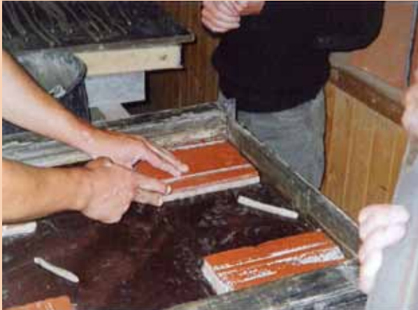
In de zelfbouwwerkplaats moeten de tegels in een mal worden geplaatst. (foto: Jean-Marie Merveille)
