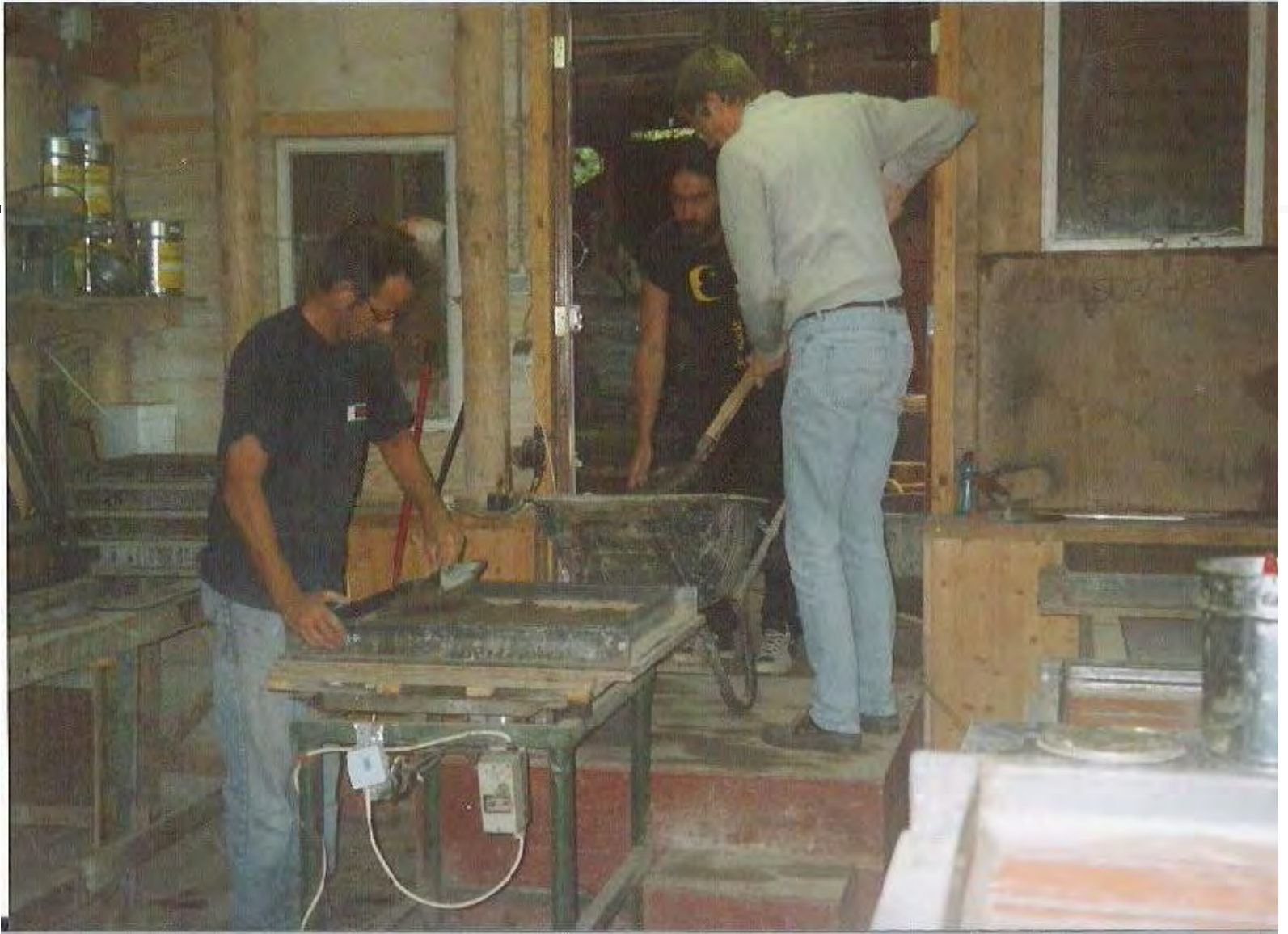
Op de triltafel volgieten met vuurbeton
